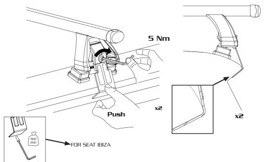
FR: Serrer alternativement chaque côtè EN: Tighten alternately ES: Apriete los tornillos alternativamenteIT: Serrare in modo alternato
