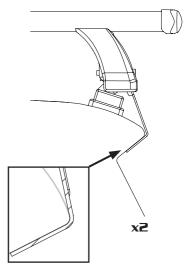
FR: Serrer alternativement chaque côtè ES: Apriete los tomillos alternativamente DE: Die Schrauben abwechselnd anziehen EN: Tighten alternately IT: Serrare in modo alternato
