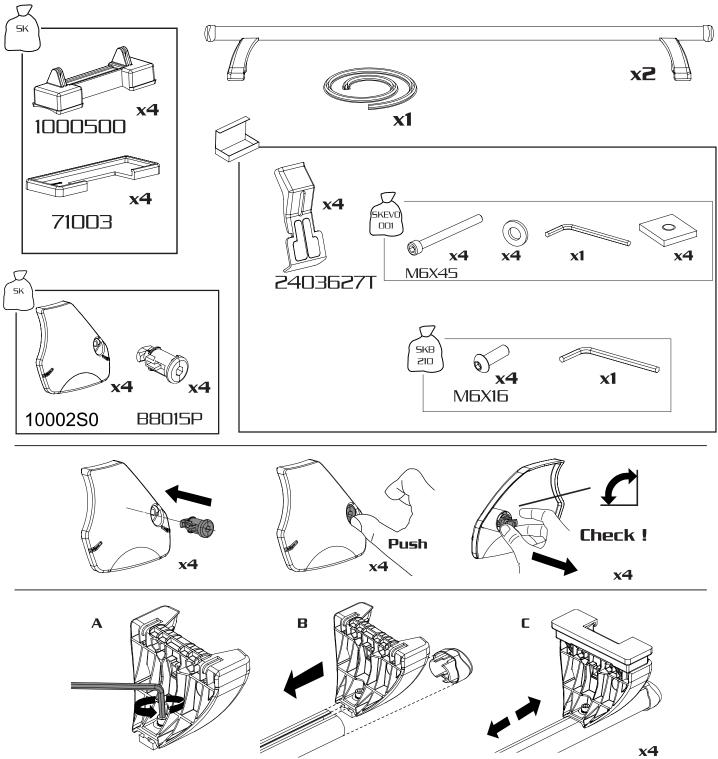
in caso di piedi pre montati saltare le fasi À e B - in case of pre-assembled feet skip phases A and B - en cas de pieds pré-montés, sauter les phases A et B - im Falle vormontierter Füße die Phasen A und B überspringen - En el caso de los pies pre-montados saltan las fases A y B
