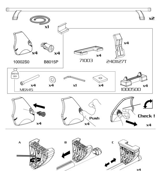
in caso di piedi pre montati saltare le fasi A e B - in case of pre-assembled feet skip phases A and B en cas de pieds pré-montés, sauter les phases A et B - im Falle vormontierter Füße die Phasen A und B überspringen - En el caso de los pies pre-montados saltan las fases A y B
