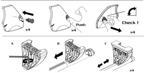
in caso di piedi pre montati saltare le fasi A e B - in case of pre-assembled feet skip phases A and B - en cas de pieds pré-montés, sauter les phases A et B - im Falle vormontierter Füße die Phasen A und B überspringen - En el caso de los pies pre-montados saltan las fases A y B
