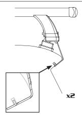
FR: Serrer alternativement chaque côtè ES: Apriete los tornillos alternativamente DE: Die Schrauben abwechselnd anziehen EN: Tighten alternately IT: Serrare in modo alternato
