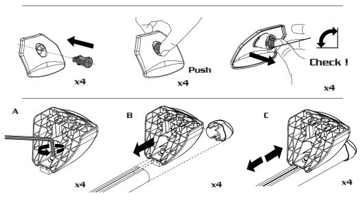
in caso di piedi pre montati saltare le fasi A e B - in case of pre-assembled feet skip phases A and B en cas de pieds pré-montés, sauter les phases A et B - im Falle vormontierter Füße die Phasen A und B überspringen - En el caso de los pies pre-montados saltan las fases A y B
