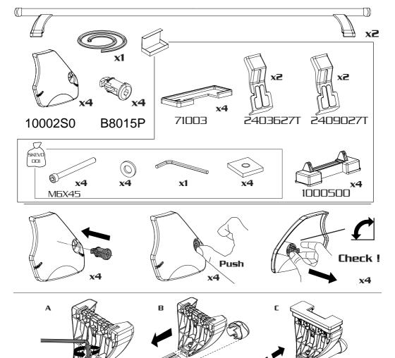
in caso di piedi pre montati saltare le fasi A e B - in case of pre-assembled feet skip phases A and B - en cas de pieds pré-montés, sauter les phases A et B - im Falle vormontierter Füße die Phasen A und B überspringen - En el caso de los pies pre-montados saltan las fases A y B
