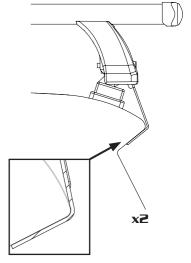
FR: Serrer alternativement chaque côtè ES: Apriete los tornillos alternativamente EN: Tighten alternately IT: Serrare in modo alternato
