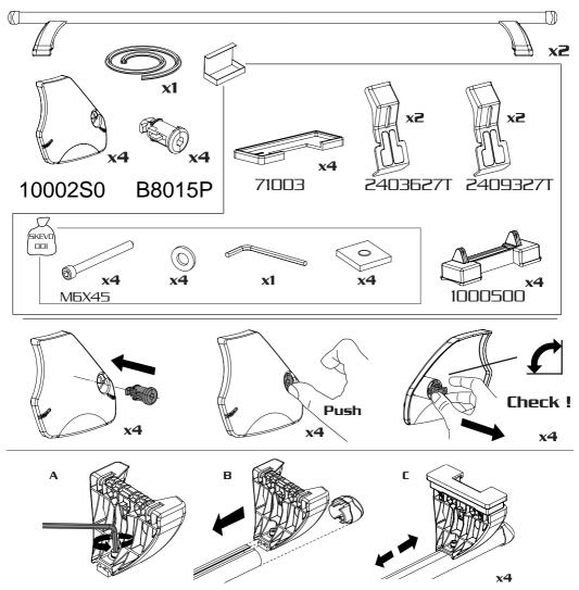
in caso di piedi pre montati saltare le fasi A e B - in case of pre-assembled feet skip phases A and B en cas de pieds pré-montés, sauter les phases A et B - im Falle vormontierter Füße die Phasen A und B überspringen - En el caso de los pies pre-montados saltan las fases A y B
