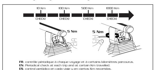
IT: controllo periodico ad ogni viaggio e a determinati Km percorsi. DE: periodische controlle bei jeder reise und in bestimm ten Km.
