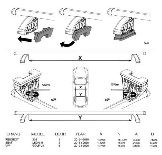
Toujours respecter les dimensions indiquées dans le tableau, pour tout doute, contactez votre revendeur Respetar siempre, las dimensiones indicadas en la tabla, para cualquier duda, contacte su distribuidor Rispettare sempre, le dimensioni indicate in tabella, per ogni dubbio contattare il vostro rivenditore Always respect, the dimensions shown in the table, for any doubt contact your dealer
