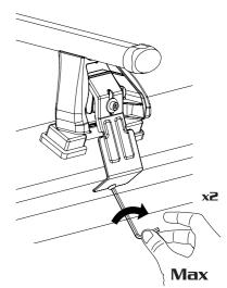
FR: Serrer alternativement chaque côtè ES: Apriete los tornillos alternativamente DE: Die Schrauben abwechselnd anziehen EN: Tighten alternately IT: Serrare in modo alternato
