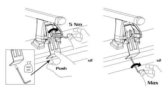
FR: Serrer alternativement chaque côtè ES: Apriete los tornillos alternativamente DE: Die Schrauben abwechselnd anziehen EN: Tighten alternately IT: Serrare in modo alternato
