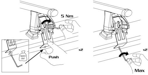
FR: Serrer alternativement chaque côtè ES: Apriete los tornillos alternativamente DE: Die Schrauben abwechselnd anziehen
