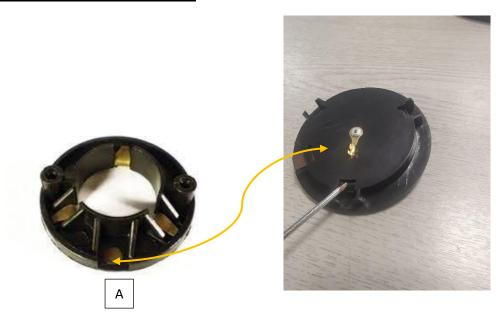
IT IS RECOMMENDED TO SOLDER THE WIRE ONTO THE SLIP RING AT THE POINT "A" SHOWN.
