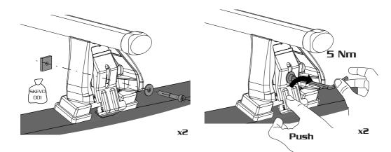
FR: Serrer alternativement chaque côtè ES: Apriete los tornillos alternativamente DE: Die Schrauben abwechselnd anziehen EN: Tighten alternately IT: Serrare in modo alternato
