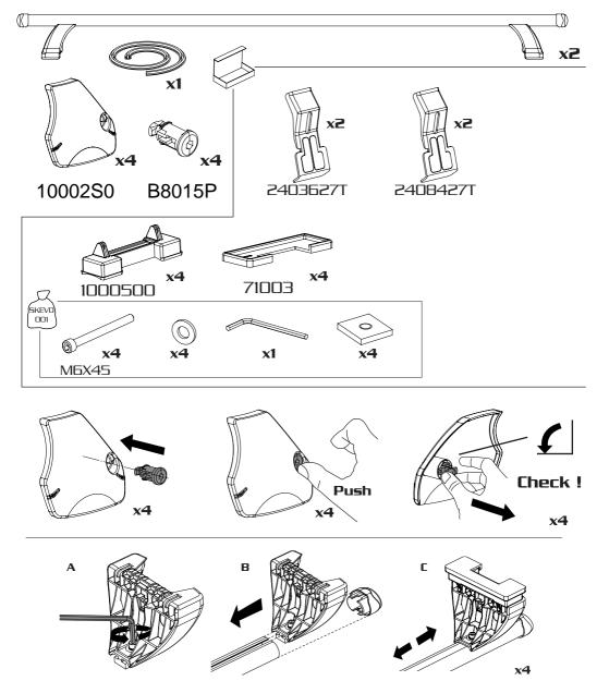
in caso di piedi pre montati saltare le fasi A e B - in case of pre-assembled feet skip phases A and B en cas de pieds pré-montés, sauter les phases A et B - im Falle vormontierter Füße die Phasen A und B überspringen - En el caso de los pies pre-montados saltan las fases A y B
