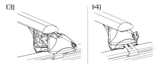
Steel bars 2 lock + 2 Plastic Lock ; Aluminium bars 4 lock Barres Acier 2 lock + 2 Plastic Lock ; Barres Aluminium 4 lock Barre Acciaio 2 Serrature + 2 serrature in plastica ; Barre Alluminio 4 serrature Stahlstange mit 2 schlösser ; Alustangen mit 4 schlösser
