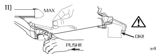
EN: Tighten your feet alternately on each side of the bar FR: Serrer alternativement les pieds de chaque coté de la barre. IT: Serrare i piedi in modo alternato ad ogni lato della barra ES: Apriete alternativamente los pies a cada lado de la barra. DE: Die Schrauben abwechselnd anziehen
