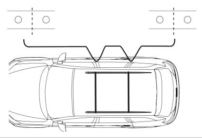
EN: If the vehicle is equipped with original fix points, place the bars in the middle of them F : Si le véichule est équipé avec points de fixage d'origine, placer les barres de toit en correspondance d'entre eux
