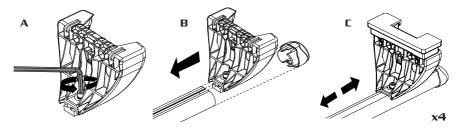
in caso di piedi pre montati saltare le fasi A e B - in case of pre-assembled feet skip phases A and B en cas de pieds pré-montés, sauter les phases A et B - im Falle vormontierter Füße die Phasen A und B überspringen - En el caso de los pies pre-montados saltan las fases A y B
