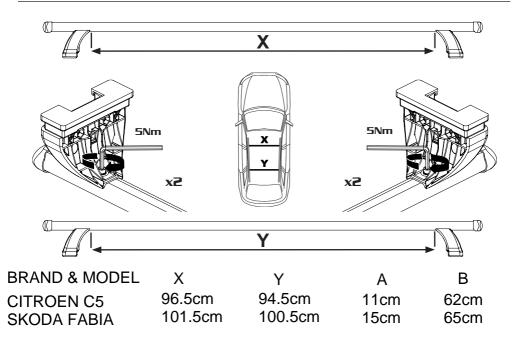
Toujours respecter les dimensions indiquées dans le tableau, pour tout doute, contactez votre revendeur Respetar siempre, las dimensiones indicadas en la tabla, para cualquier duda, contacte su distribuidor Rispettare sempre, le dimensioni indicate in tabella, per ogni dubbio contattare il vostro rivenditore Always respect, the dimensions shown in the table, for any doubt contact your dealer
