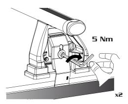
FR: Serrer alternativement chaque côtè ES: Apriete los tornillos alternativamente DE: Die Schrauben abwechselnd anziehen
